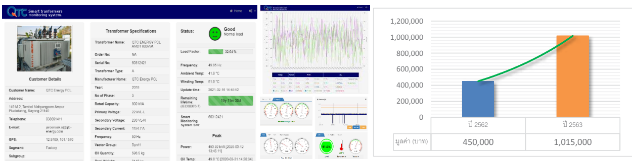
ตัวอย่างการแสดงผลค่าต่าง ๆ ใน Smart Transformer Monitoring System V3.1
