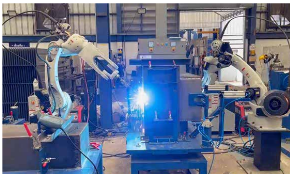
ภาพตัวอย่างการเชื่อมประกอบฝาถัง 300kVA (MEA) และตัวถัง 50kVA (PEA)
