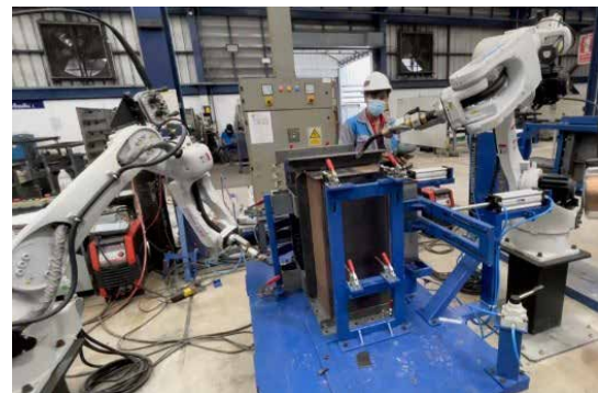
ภาพตัวอย่างการเชื่อมประกอบฝาถัง 300kVA (MEA) และตัวถัง 50kVA (PEA)
