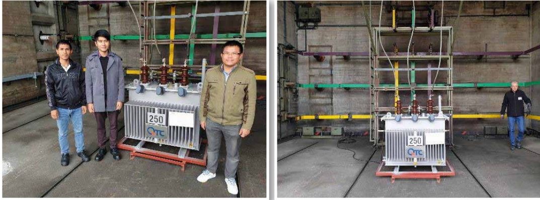
ภาพการทดสอบ Short Circuit Performance Test ณ ห้องปฏิบัติการทดสอบ FGH Engineering & Test GmbH ประเทศเยอรมนี
